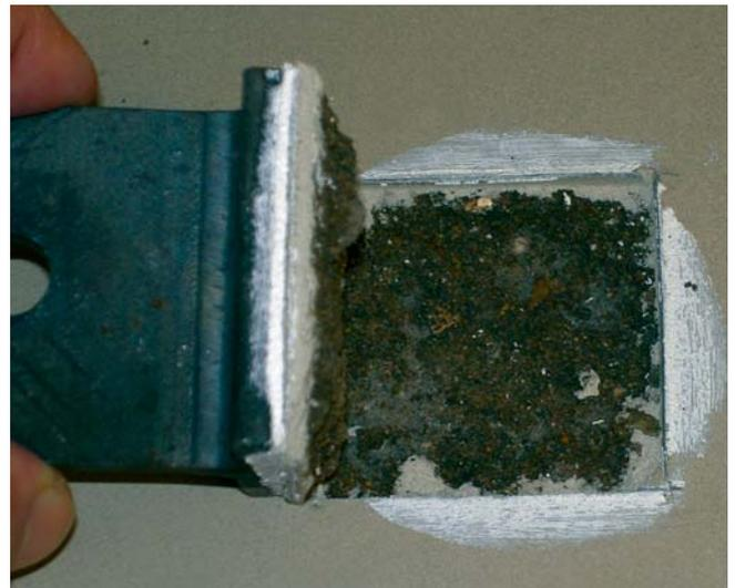
Проверка прочности на отрыв на упрочненной и прошпаклеванной цементной стяжке.
