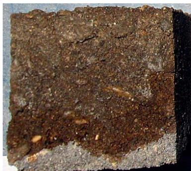
Толщина стяжки составляет здесь 40 мм, UZIN PE 425 проникает при 2-кратном нанесении приблизительно на 35 мм в глубину стяжки, упрочняя ее
